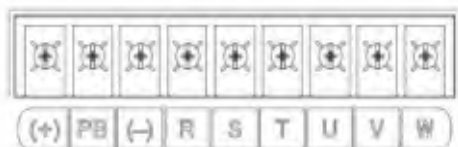
شکل ۴-۸: ترمینال های مدار اصلی برای مدل (VX40)18.5kW-30kW
