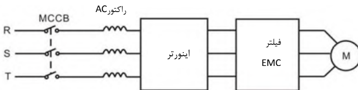
نصب فیلتر EMC در خروجی درایو
